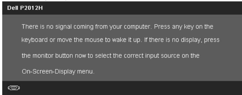
Jika input VGA atau DVI-D terpilih dan kedua kabel VGA dan DVI-D tidak tersambung, kotak dialog mengambang seperti yang ditunjukkan di bawah ini akan muncul. Monitor akan masuk ke Mode Hemat Energi setelah 5 menit jika dibiarkan dalam keadaan ini.
